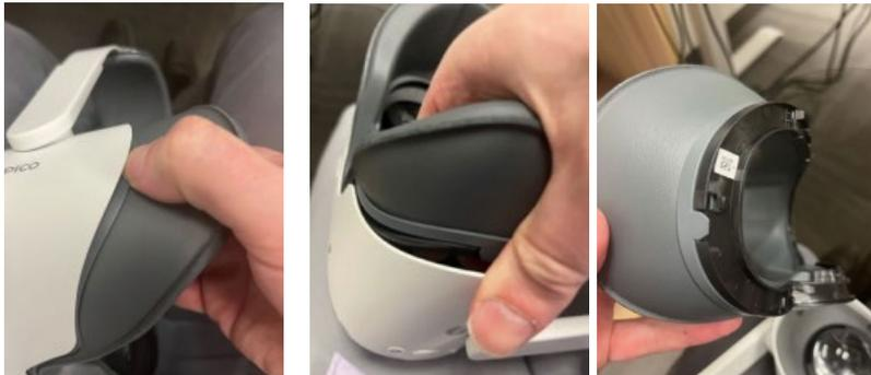
轻轻地将黑色内衬从旧面罩上分离，并将其安装到新面罩上，并确保接合点正确夹紧。
