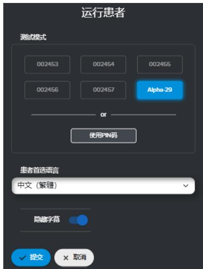
在“开始测试”对话框中，选择设备并指定“患者首选语言”和“隐藏式字幕”选项，然后点击**提交**按钮将启动设备上的对准和眼动追踪校准步骤。同时，确认以下患者信息，包括患者所佩戴的屈光矫正装置，然后单击**提交**按钮。一旦完成眼动追踪校准步骤，患者就继续进行对准测量。
